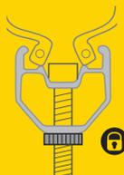
Serrer la valve et s'assurer que le pneu tubeless a été correctement installé avant de gonfler.
