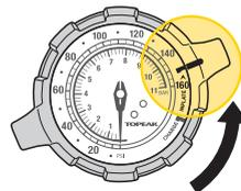
Relâcher l'air et positionner le sélecteur sur **INFLATE** après chaque utilisation. Pour des raisons de sécurité, NE PAS laisser la chambre à air sous pression lorsque la pompe n'est pas utilisée.
